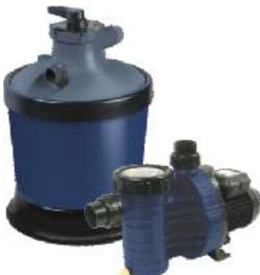
Písková filtrace MGi je vyrobena revoluční technologií vstřikováním ABS do formy. Tato metoda zaručuje nízkou cenu a vysokou kvalitu. Filtrace se skládá pouze ze dvou částí z čehož jedna má integrovaný 6-ti cestný ventil 1 1/2". Manometr, vypouštění vody. Silné a odolné samonasávací čerpadlo Aquaplus s připojovacím šroubením 50mm. Základna z ABS.
